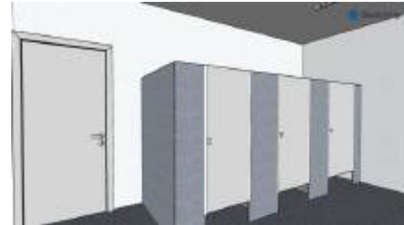
Imagem 01: Perspectiva das divisórias padronizadas no acabamento granito cinza andorinha, portas das cabines e porta de acesso na cor cinza claro, piso em peças de granito cinza andorinha, paredes com revestimento cerâmico na cor branca, rebaixo em gesso com pintura na cor branca e iluminação em luminária tubular com lâmpada LED.
