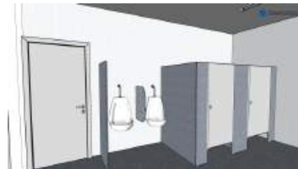
Imagem 02: Perspectiva das divisórias padronizadas no acabamento granito cinza andorinha, portas das cabines e porta de acesso na cor cinza claro, piso em peças de granito cinza andorinha, paredes com revestimento cerâmico na cor branca, rebaixo em gesso com pintura na cor branca, iluminação em luminária tubular com lâmpada LED e mictórios separados por divisórias em granito cinza andorinha.
