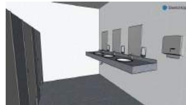
Imagem 03: Perspectiva das bancadas em granito cinza andorinha, com cubas ovais na cor branca de embutir, torneiras com arejador e temporizador, torneira de tanque para limpeza sob a bancada, espelhos retangulares (50x80 cm) junto a cada cuba com dispenser para sabonete e papelera.
